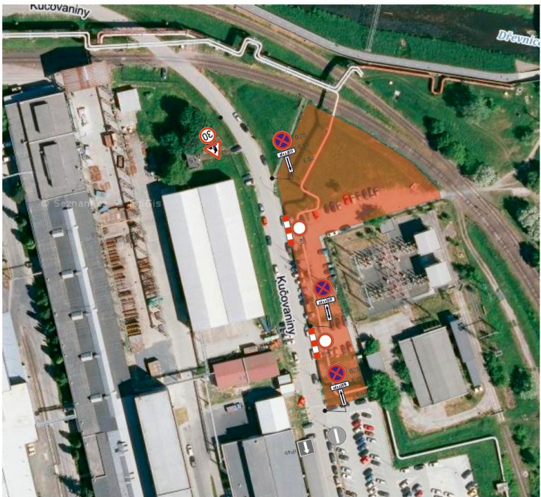
Dopravní značení během výstavby parkovací plochy:
