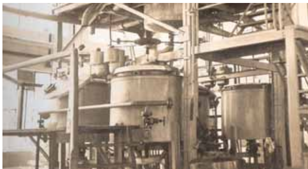
Polymerizační kotle užívané při výrobě chloropren kaučuku. Foto: archiv Organiku
