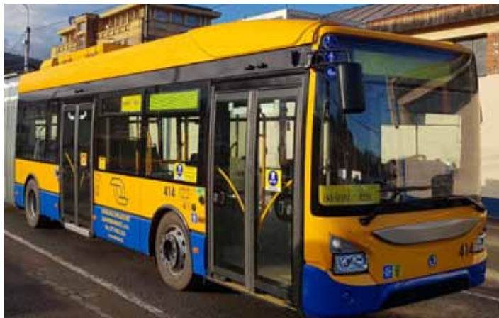
Zatím bez cestujících. Nový článkový trolejbus má délku osmnáct metrů a ujede až deset kilometrů mimo trolejové vedení.
